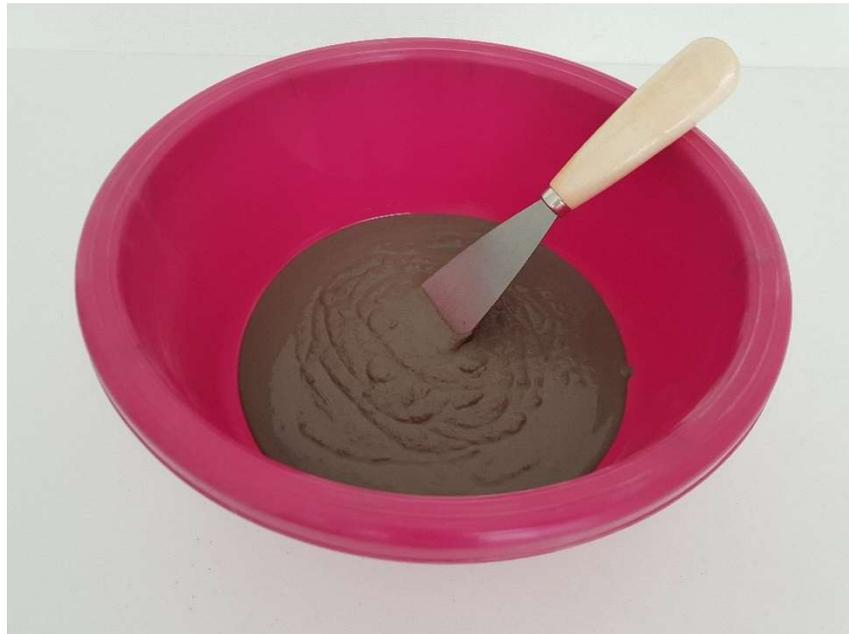
Für die Silikonform sollte die Masse nicht zu zähflüssig sein. Sobald die gewünschte Konsistenz erreicht ist, wird die gut eingölte Silikonform mit dem vorbereiteten Beton befüllt. Die Form vorsichtig rütteln oder mit einem Stäbchen den Beton verdichten damit sich die Luftblasen lösen.
